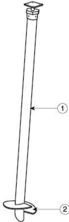
**Figure 1. Produit « HELICAL PILE »**
